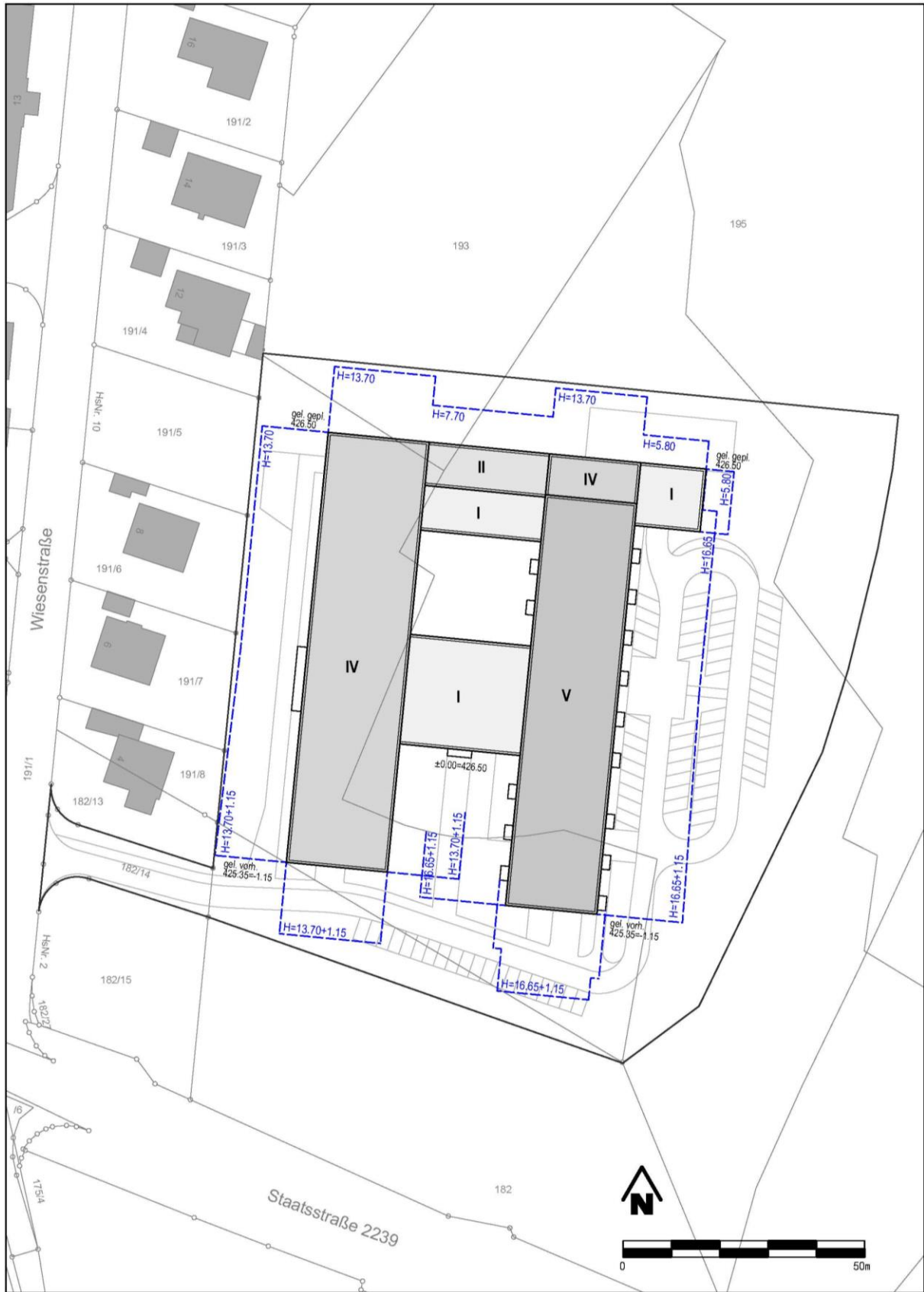
Abbildung 5: Abstandsflächenplan des Seniorenzentrums, Stand 04.09.2019 (Engelhardt Architekten, Schwabach)
